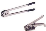
Tensora (FM TM 19-32) y Pinza (FM TM 19-32) para flejado plástico de alta tensión con unión, pueden ser usadas conjunta o independientemente aunque para conseguir un óptimo resultado es recomendable el uso combinado.
