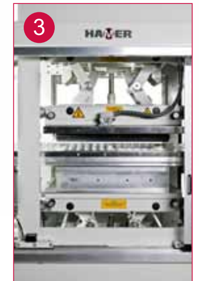
Estación de troquelado
