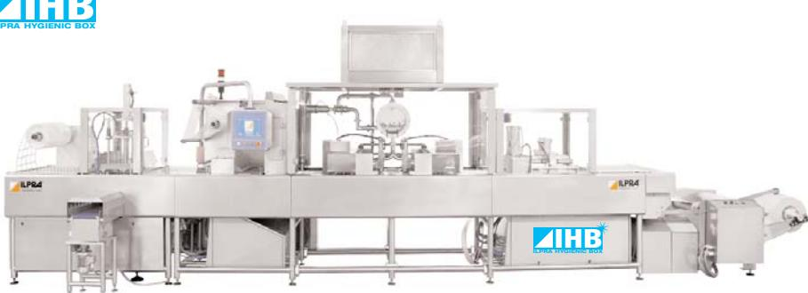
■ ■ I cinematismi sono racchiusi all'interno di speciali contenitori ermetici denominati **ILPRA Hygenic Box** che impediscono l'accumulo di eventuali residui alimentari. + sistema igienizzazione Ad ulteriore garanzia della massima pulizia e igienicità, la struttura portante è inoltre realizzata con tubolari in acciaio inossidabile a sezione circolare.
