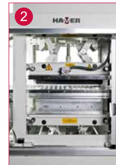
Estación de troquelado
