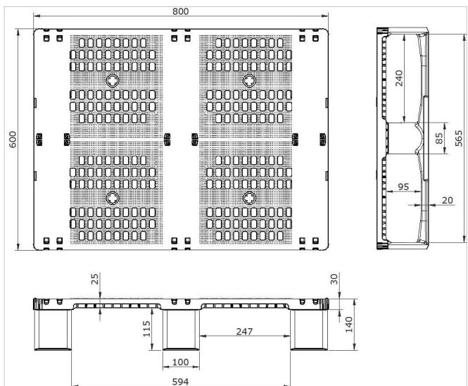
\* Los valores indicados son orientativos, y se basan tanto en experiencias prácticas como en ensayos ISO 8611 con una carga estándar uniformemente repartida, distribuida por toda la superficie del palet y durante un tiempo determinado a temperatura ambiente (20°C). Distintas condiciones de carga producen valores diferentes que han de ser comprobados a petición del cliente. Cualquier deterioro o rotura en el palet puede variar estos resultados.
