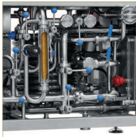
FLUSSIMETRO CON TUBO DI VETRO PER CONTROLLO LIMPIDEZZA MOSTO E VELOCITÀ DI FILTRAZIONE. FLOWMETER WITH GLASS PIPE TO CHECK WORT CLARITY AND FILTRATION SPEED.
