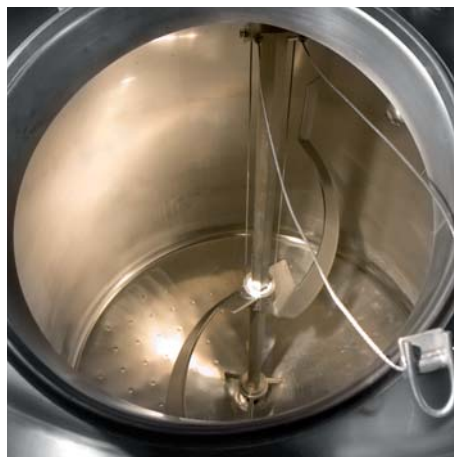
DISPOSITIVO SOLLEVAMENTO PALE AGITATORE PER WHIRLPOOL. AGITATOR-BLADE LIFTING DEVICE FOR WHIRLPOOL.
