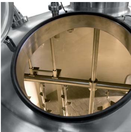
DISPOSITIVO TAGLIO TREBBIE. RAKE TO CUT SPENT GRAIN.
