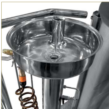
LAVELLO CON SISTEMA RAFFREDDAMENTO CAMPIONE MOSTO CALDO. SINK WITH WORT SAMPLE COOLING SYSTEM.
