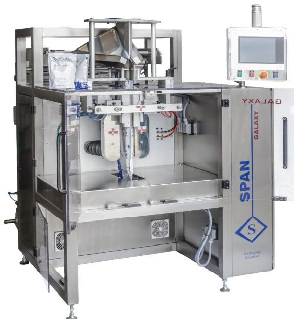
La envasadora vertical Span Galaxy Doypack hace bolsas en formato Doypack partiendo de bobina. De gran velocidad (servomotorizadas), fabricada en Acero Inoxidable y con conexión ethernet para sincronizar con Base de datos.
