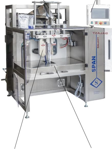
El **SISTEMA DE ARRASTRE** del film se efectúa mediante correas perforadas para el uso de bomba de vacío
