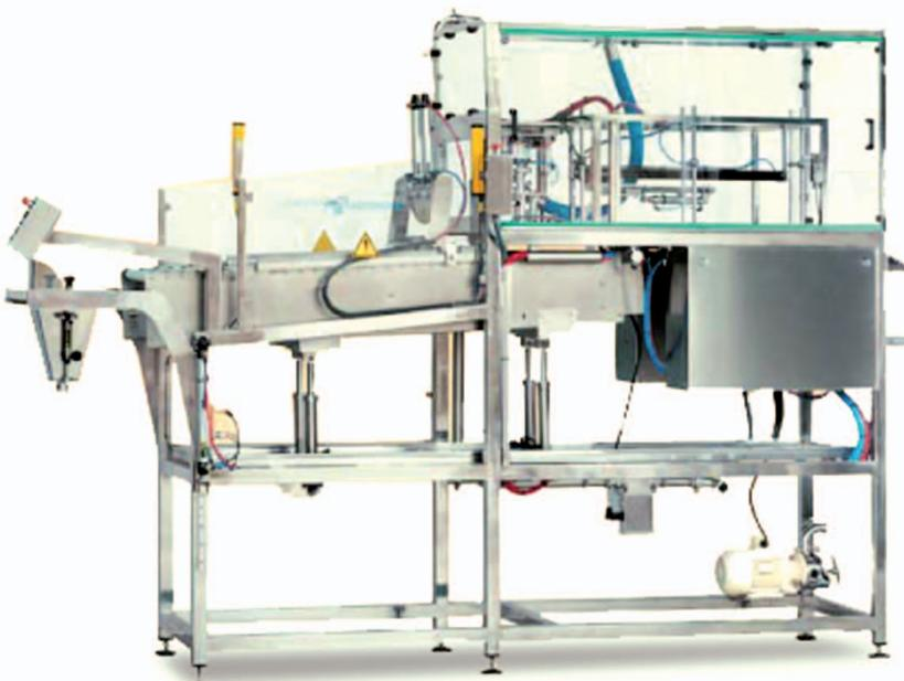
La **ECOFILL MASTER** es una envasadora automática para bolsas en continuo de última generación, rápida, precisa y de rápido cambio de formato. Está equipada con un contador magnético de alta precisión.
