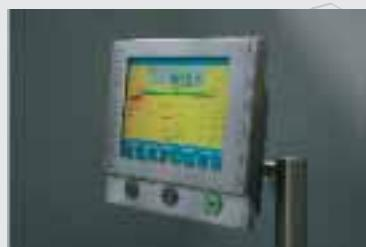
→ Terminal de operador rotable y girable de acero afinado con una pantalla multisensible multicolor y teclas de manejo Piezo (IP 69K).
