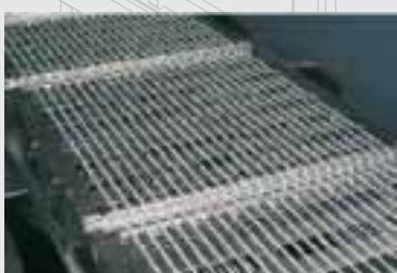
→ La construcción abierta evita una deposición de residuos de los productos y garantiza una limpieza continua con una valoración de limpieza ideal.
