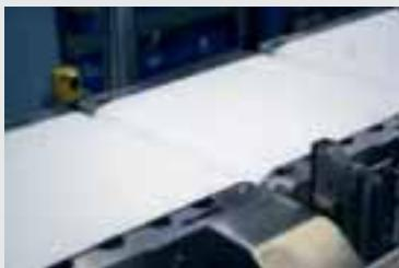
→ Barrera fotoeléctrica de entrada (IP 69K) regulable de forma universal para la identificación segura y precisa de los productos.
