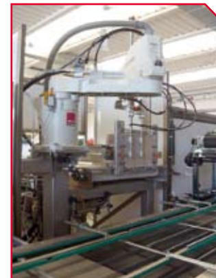
Robot mettalveare / Bottle divider inserted by robot / Robot insertador de separadores de celdillas / Robot positionneur d'alvéole / Roboter zum Einsetzen der Trenner / Robot установщик ячеек
