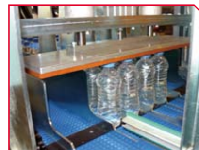
Separazione Alternata / Standard separation / Separación alternada / Séparation alternée / Getaktete Trennung / Поочередное разделение
