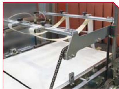
Avvolgimento film con nastri autocentranti / Film wrapping with self centering belts / Envoltura film con cintas auto-centrales / Enroulement film avec bandes auto-centrées / Folienabwicklung mit selbstzentrierenden Bändern / Обматывание пленкой с помощью самоцентрирующихся ленточек
