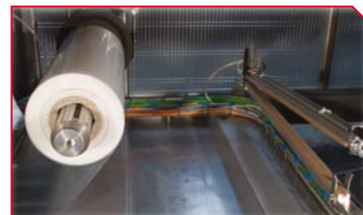
Saldatore con portabobina film / Heat sealer with film reel holder / Soldador con portabobina film / Scelluse avec porte-bobine film / Siegelvorrichtung mit Folienrollenhalter / Сварочный узел с держателем пленки
