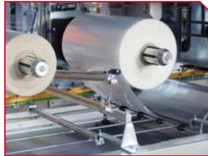
Saldatore con doppio portabobina film / Heat sealer with double film reel holder / Soldador con doble portabobina film / Scelleuse avec double porte-bobine film / Siegelvorrichtung mit doppeltem Folienrollenhalter / Сварочный узел с двойным держателем пленки
